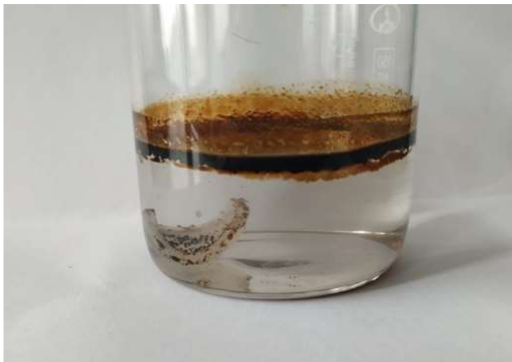
13 сурет-ісінген гельдің мұнай+су қоспасындағы сорбциясы
