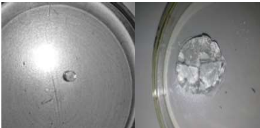
5 сурет—Суға салынған гидрогельдің бастапқы және ісінген түрі
