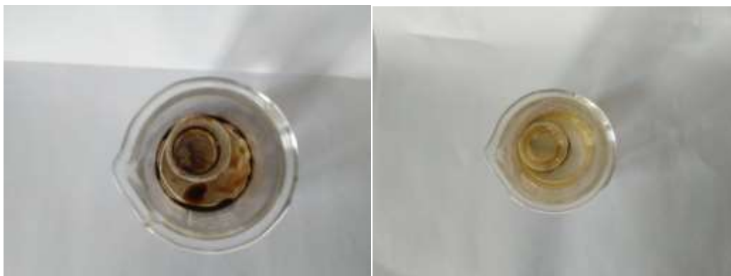
12 сурет-ісінген гелдің мұнай+су және мотор майы+су с сорбциясы
