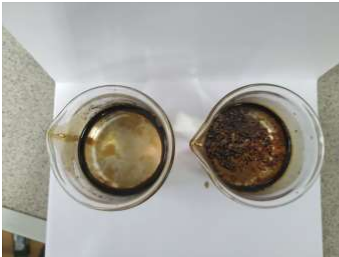
11 сурет-мұнай+су қоспасына а)ісінген жәнев)кристалл күйіндегі гельді қосу арқылы жүргізілген сорбция
